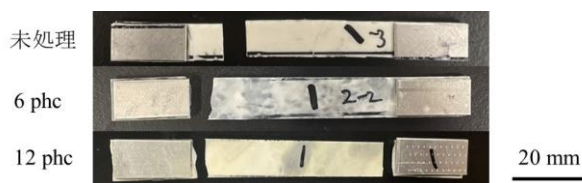
図 2 高温引張試験後のステアリン酸処理 TCP/PLA 試験片の外観写真
