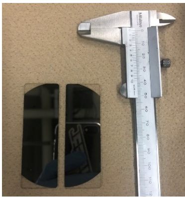
図4 ガラス基板上に作製した HEA 薄膜.
