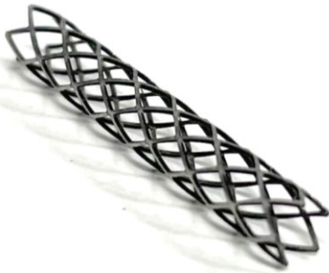
図 12. 複合プロセスにおける薄肉化・表面の平滑化の最適条件を基に創製した生体吸収性 Mg 合金ステント 11) .
