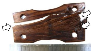
図 3 不適切な熱間プレス処理材の事例(ヒノキ)
