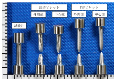
図 16 引張試験前後の試験片外観
