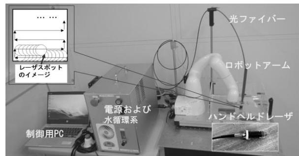
図1 ハンドヘルドレーザーをロボットアームに搭載したLP装置外観
