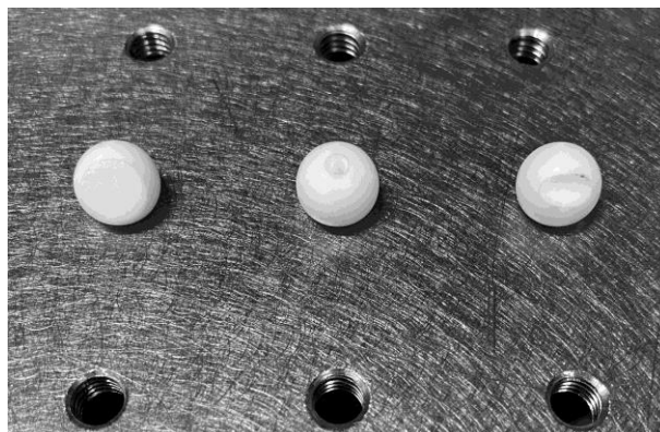
図 9：炭酸ガスレーザーを用いて作製したテフロン製フォトニックジェットレンズ。球の半径は 9.5 mm。
