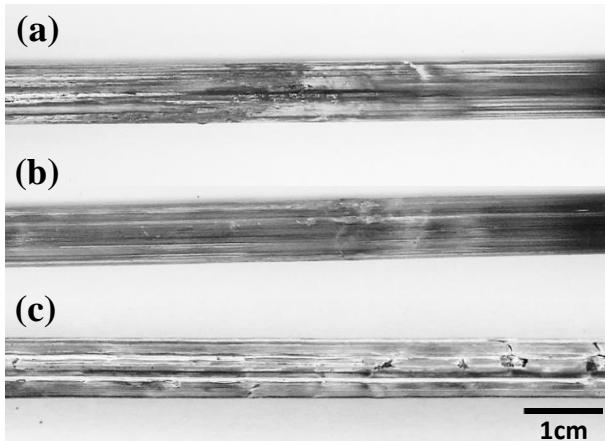
図 1 (a) 20vol%、(b) 40vol%、(c) 60vol%の黒鉛を添加した押し出し試料の外観。
