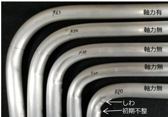
図9 偏心管の曲げ後の外観 (心材あり)
