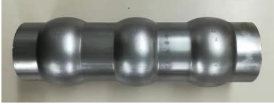
図 6. 成形した突起付き円筒型緩衝材 CAP
