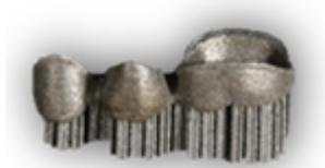
図2. SLM法で製作したブリッジ外観
