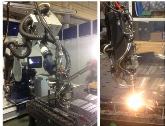
図 1 本研究で用いたファイバーレーザー溶接システムと溶接の様子
