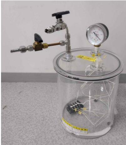
図 2 ホットストリップ法に用いた測定用チャンバの写真
