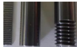
図2 プローブ形状 (左: ストレート, 右: ねじ)
