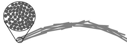
図2 屈曲状態の金属ナノワイヤー・バンドル。多数のナノワイヤーから成る断面も表示。
