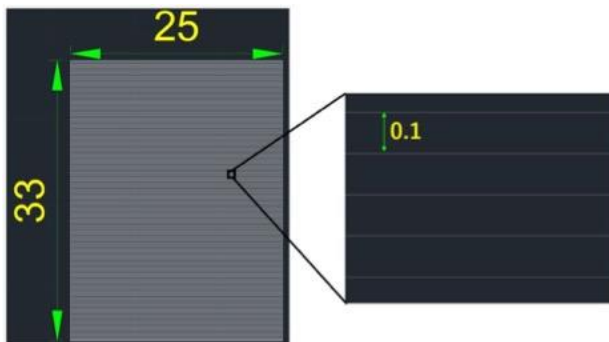
図4 薄膜に凹凸構造を設けた際の加工寸法
