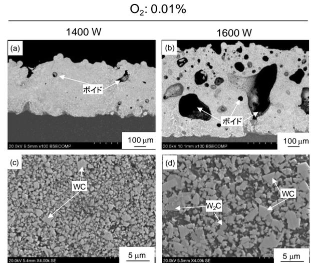
図7 チャンパー内で作製した肉盛層のSEM写真
