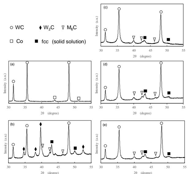
図4 原料粉末(a)および肉盛層(b-e)のXRD
