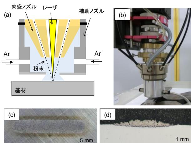
図 8 (a)補助ノズルの模式図 (b)ノズル外観写真
