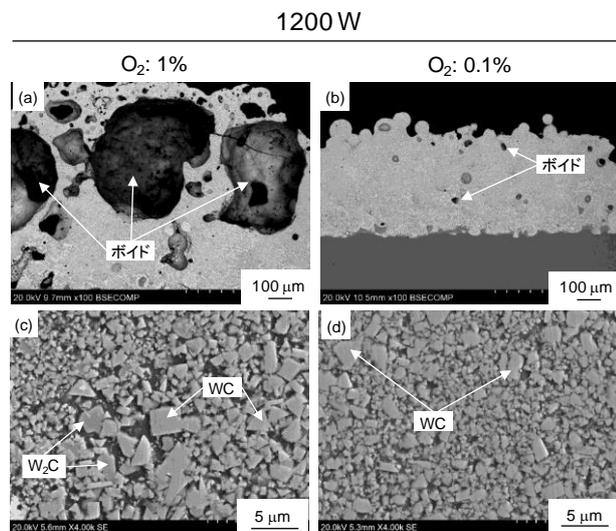
図6 チャンパー内で作製した肉盛層のSEM写真
