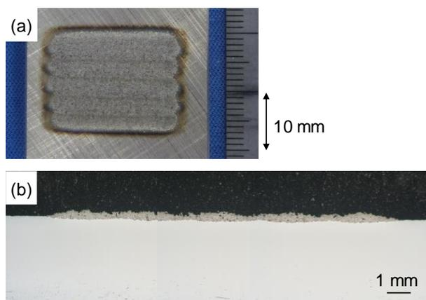
図 9 多パスによる面状コーティング処理
