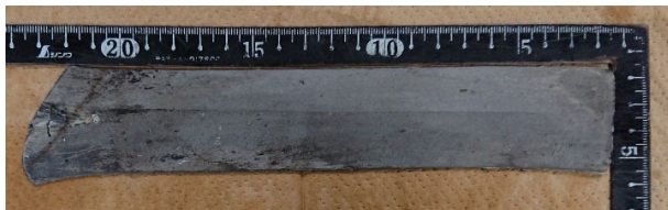
図 2 圧下率 60% で熱間圧延した直後に 400°C で恒温保持処理を施した試料の外観 ○ 。
