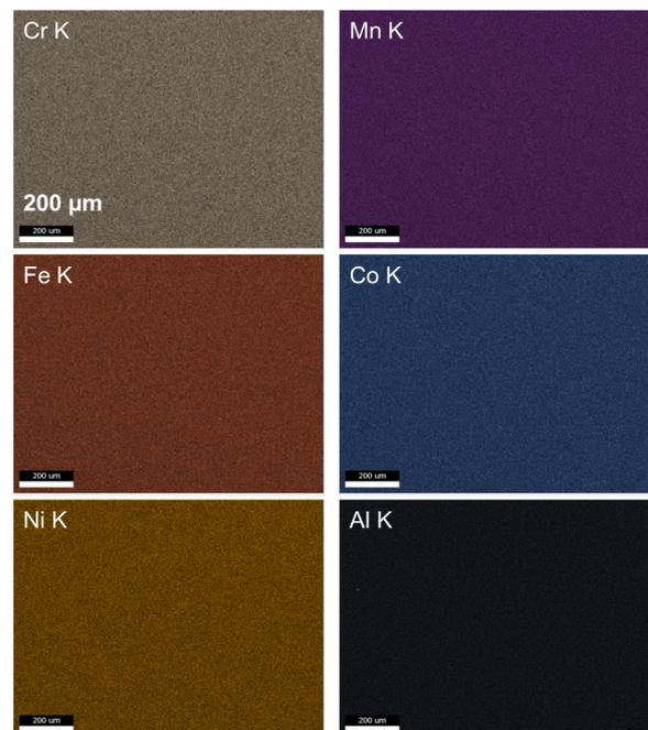
図 3 均質化処理材 ( $\text{Al}_8$  合金) の元素マッピング (EDS)
