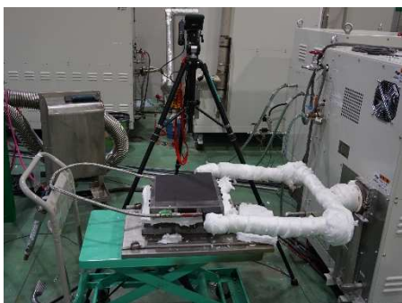
図 18. 過熱水蒸気流動試験セットアップ状態（入口両端）
