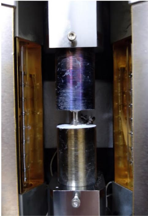
図3 高温圧縮治具および試料の外観図。
