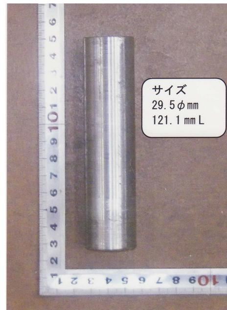
図2 作製した $V-5Cr-5Ti$ 合金の外観。
