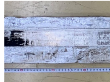
図10(e) 鋳造したクラッド (圧下率20%)
