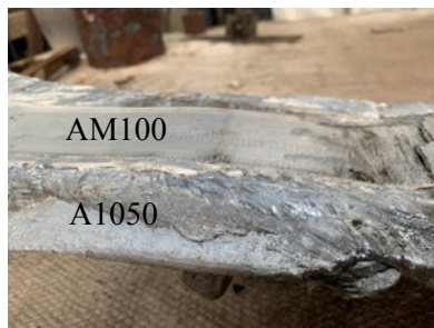
図10(c) 鋳造したクラッド (圧下率10%)
