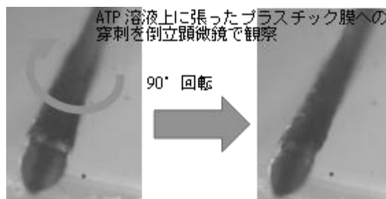
図2 蚊の針の人工皮膚上での回転運動
