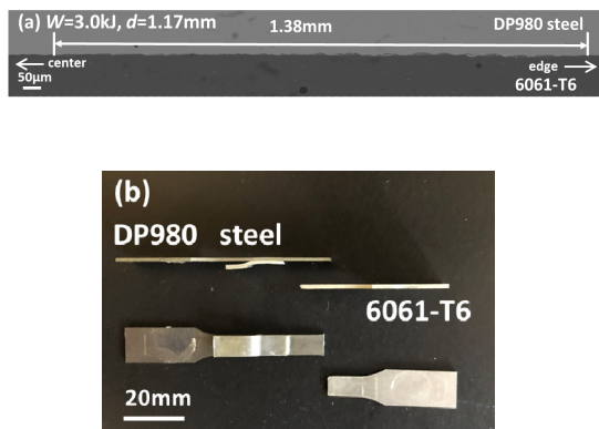
図7 (a) 6061-T6/DP980鋼接合板 ( W=3.0\text{kJ} , d=1.17\text{mm} )の断面BE像。(b) 6061-T6/DP980鋼接合板 ( W=3.0\text{kJ} , d=1.17\text{mm} )の引張せん断試験後の試験片の外観写真。
