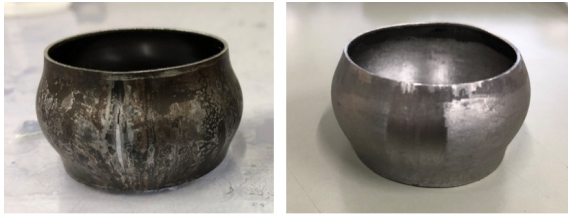
A S材 (破裂) T C P 1パス材 (破裂せず)
