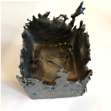
図5 Ti-Fe 合金の鋳塊
