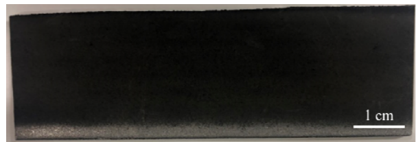
図 6 ニッケル層含有 CNT 粒子からアルミニウム基板上にコールドスプレー法により形成した被膜
