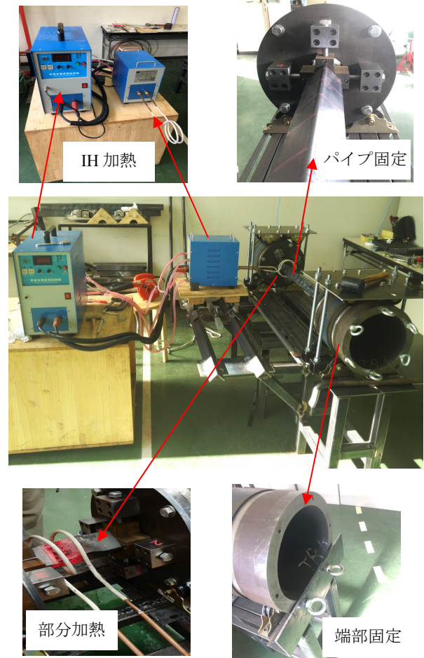
図 14. 部分加熱回転加工法の専用実験装置
