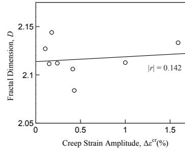
図10 フラクタル次元とクリープひずみ振幅  $\Delta\epsilon^{cr}$  の関係
