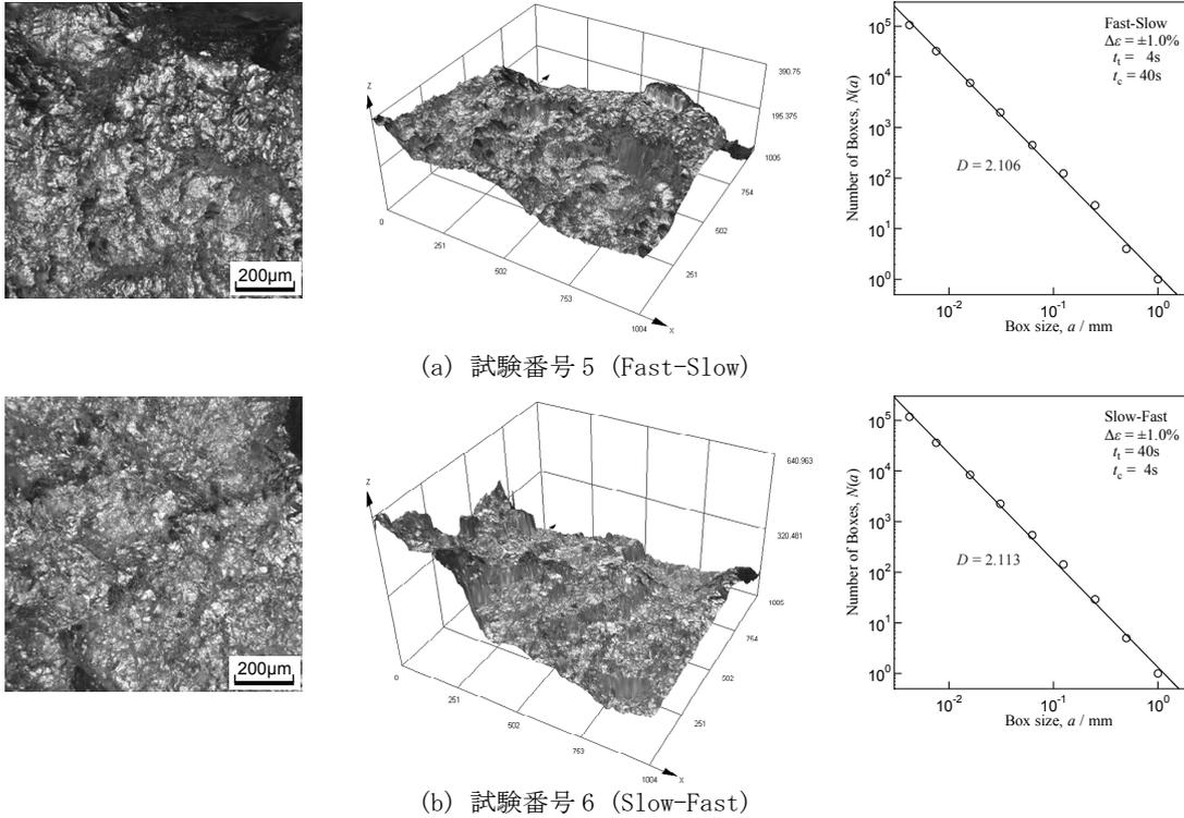
図5 Fast-SlowとSlow-Fastでの破面形態とフラクタル次元（試験番号5と6の比較）
