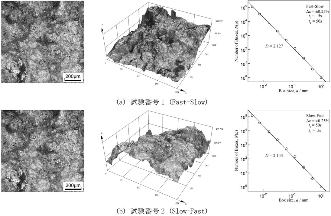
図3 Fast-Slow と Slow-Fast での破面形態とフラクタル次元 (試験番号 1 と 2 の比較)
