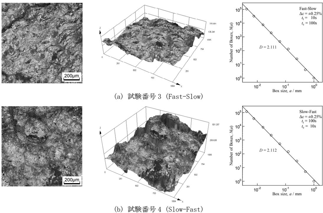
図4 Fast-Slow と Slow-Fast での破面形態とフラクタル次元 (試験番号 3 と 4 の比較)
