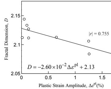
図11 フラクタル次元と塑性ひずみ振幅  $\Delta\epsilon^{pl}$  の関係
