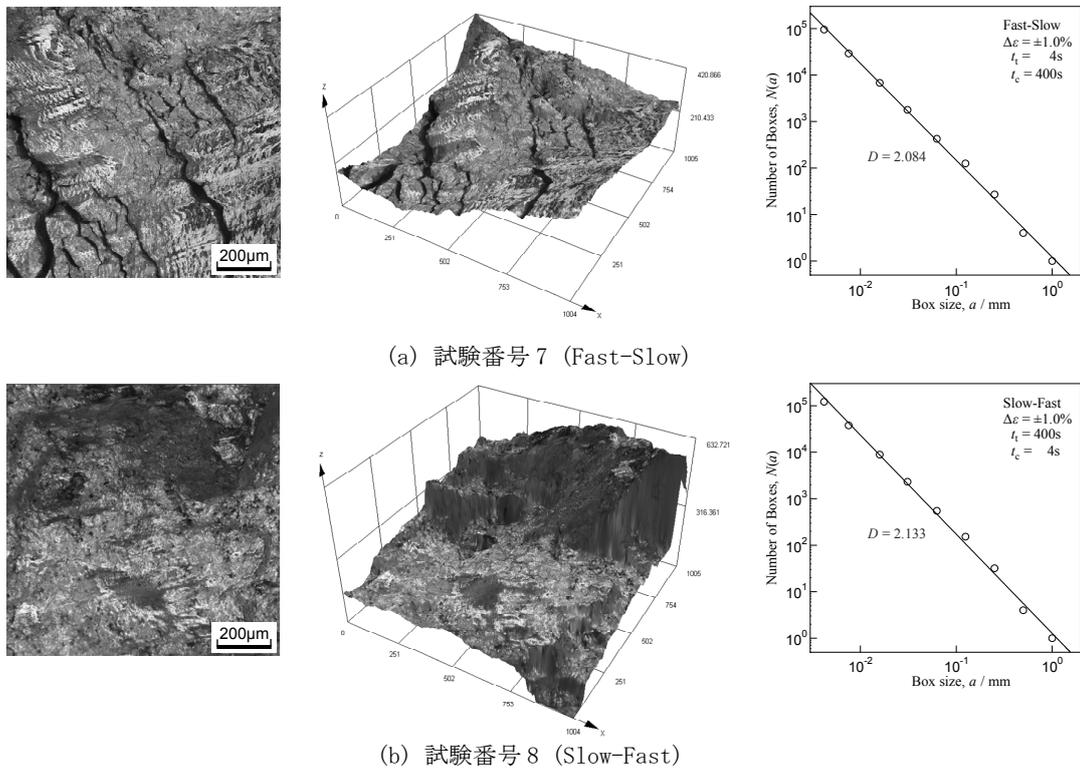
図6 Fast-SlowとSlow-Fastでの破面形態とフラクタル次元（試験番号7と8の比較）
