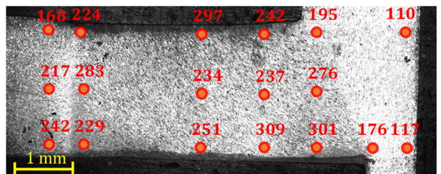
図13 せん断変形領域周辺のビッカース硬さ分布 7)
