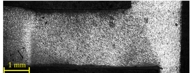
図12 せん断変形領域の鍛造線( t_0/t_{c0} = 0.55 )
