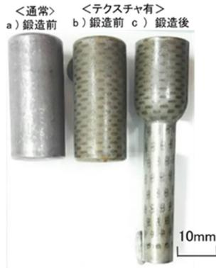
Fig.2 テクスチャの有無による鍛造前後の試料外観
