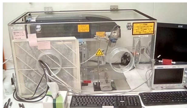
図1 (上図)炭酸ガスレーザーと測定系。装置全体をアクリル製ボックス内に設置し、ターゲットをレーザー直下に設置しレーザー照射した。
