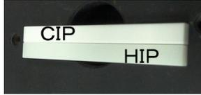
図2 2種類の素材から作製した試験片
