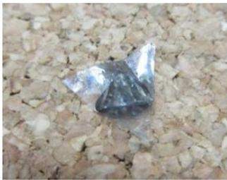
図 11 銀ナノ薄膜転写ピラミッド体
