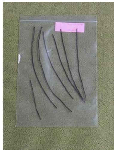
図 1 7 試作したフィラメントの外観
