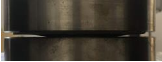
図 17. CF RTP シート成形品の圧縮の様子
