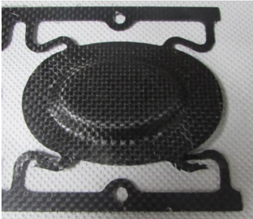
図 10. 加熱温度 230℃の実験結果
