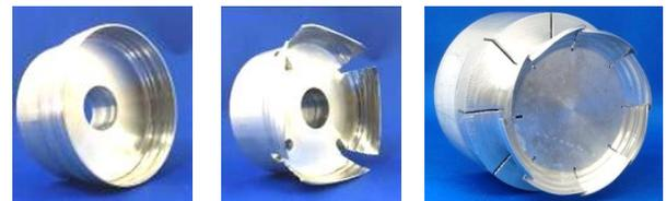
図6 旋削・曲げの逐次加工の例(幅1mm, 高さ5mm $\times$ 4)
