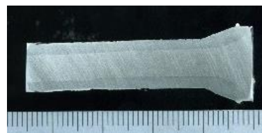
図 7 3層で構成された Al 系傾斜機能材料の断面(中心:純 Al, 中間層:5vol.% Al 2 O 3 , 外周:10vol.% Al 2 O 3 )
