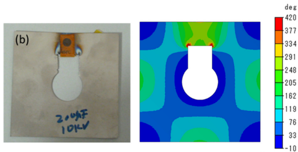
図 10 FEM 解析による純チタン表面上の温度分布
