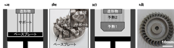
図 1 (a)サポートあり造形プロセス, (b)サポートあり造形プロセスによる造形物 4) , (c)サポートレス造形プロセス, (d)サポートレス造形プロセスによるタービンプレード。
