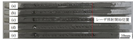
図10 平均投入エネルギー密度を一定として出力と移動速度を変化させた時の熔融凝固部の比較。
