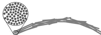
図2 屈曲状態の金属ナノワイヤー。ここでは大きな比表面を例示するため、多数のナノワイヤーからなるバンドルとして表示している。
