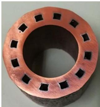
図 17 回収された複雑な内部構造を持つユニポア材<sup>13)</sup>
