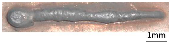
図 6 高速大体積積層検討の第 1 層ビード外観
