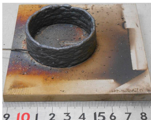
図 9 円筒積層実験結果の一例と積層中の様子
