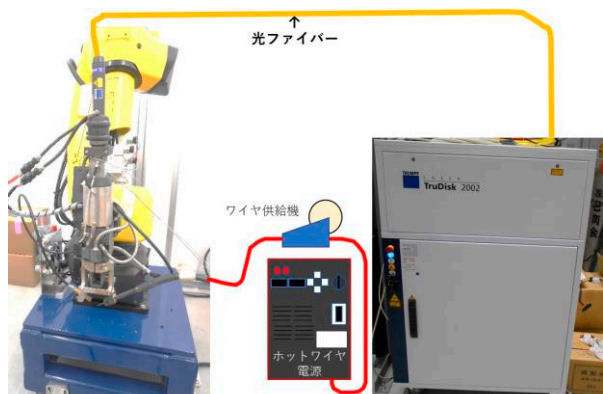
図 7 造形実験用ホットワイヤ装置の駆動部と発振器
