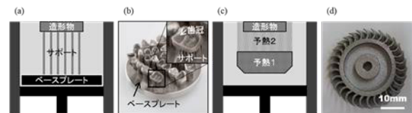
図 1 (a)サポートあり造形プロセス, (b)サポートあり造形プロセスによる造形物 2) , (c)サポートレス造形プロセス, (d)サポートレス造形プロセスによるタービンブレード。
