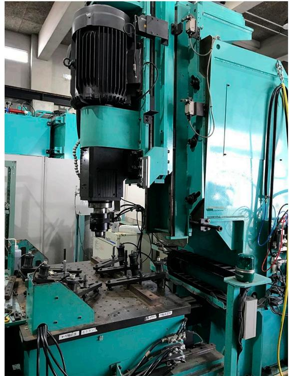
図 4 摩擦攪拌装置
