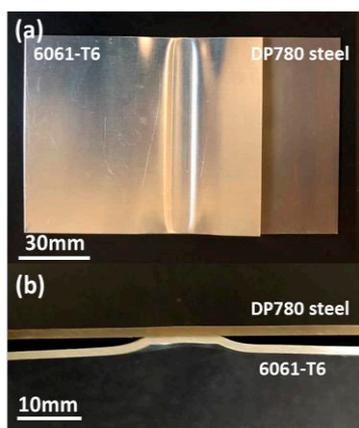
図3 (a)接合板の外観写真と(b)断面写真
