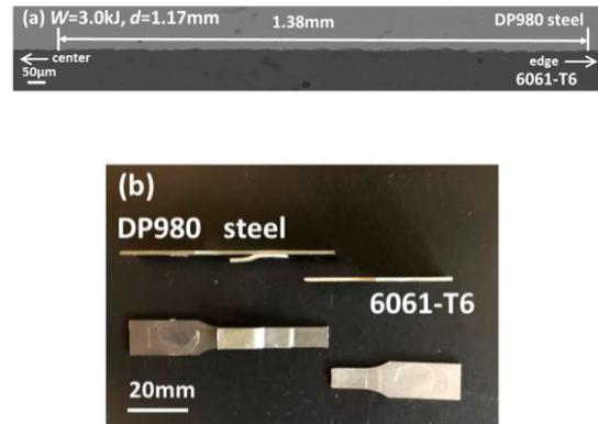
図 8 (a) 6061-T6/DP980 鋼接合板 ( $W=3.0\text{kJ}$ ,  $d=1.17\text{mm}$ )の断面 BE 像.(b) 6061-T6/DP980 鋼接合板 ( $W=3.0\text{kJ}$ ,  $d=1.17\text{mm}$ ) の引張せん断試験後の試験片の外観写真<sup>10)</sup>
