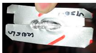
図 19 本提案手法による 0.1mm 薄 SUS304 板の線接合
