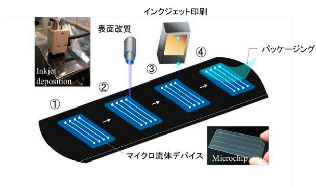
図 1 レーザ照射による表面改質とインクジェット印刷による免疫アッセイ用診断チップの連続作製
