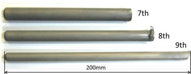
図10 初期blank直径75mmを用いた絞り加工後の第7段から第9段までの容器外観
