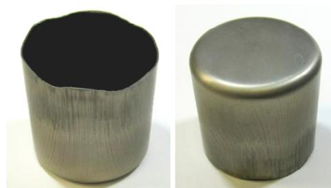
図6 初期ブランク直径92mmに対して深絞り成形した容器外観
