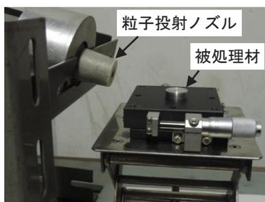
図 1 斜投射 FPP 処理装置の概観
